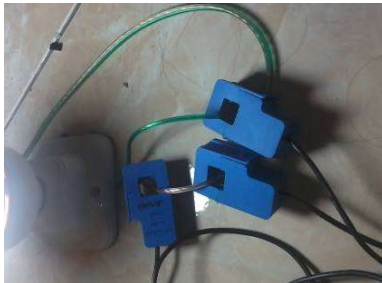
Gambar 4.9 Pengujian Dengan Kondisi Semua Sensor Arus Dikaitkan Pada Kabel
